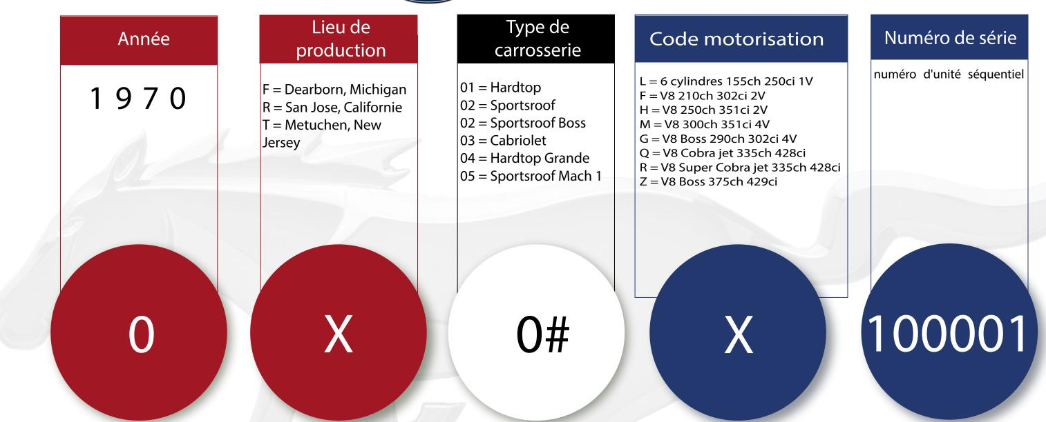
1970 Le VIN est situé sur le bord supérieur du tableau de bord, côté passager, visible à travers le pare-brise
